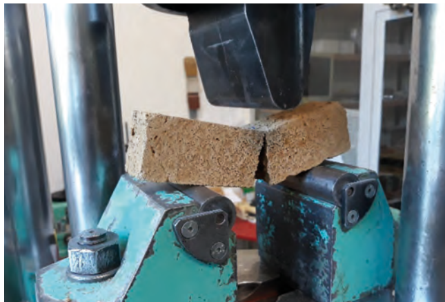
Abb. 8: Biegezugfestigkeitsprüfung eines Lehmprismas (BTI)
