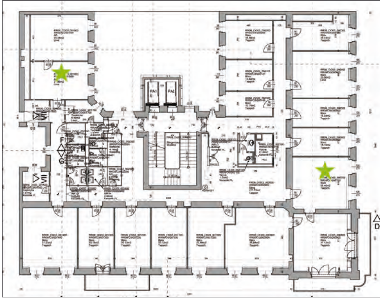
Abb. 9: Die mit grünem Stern markierten Räume sind mit Datenloggern zur Messung von Raumluftfeuchte und Raumlufttemperatur für baubegleitendes Feuchte-Monitoring ausgestattet.
