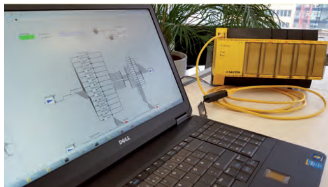
Abb. 3: Darstellung HIL Umgebung (Simulationsmodell mit realer Hardware). © AIT Austrian Institute of Technology GmbH
