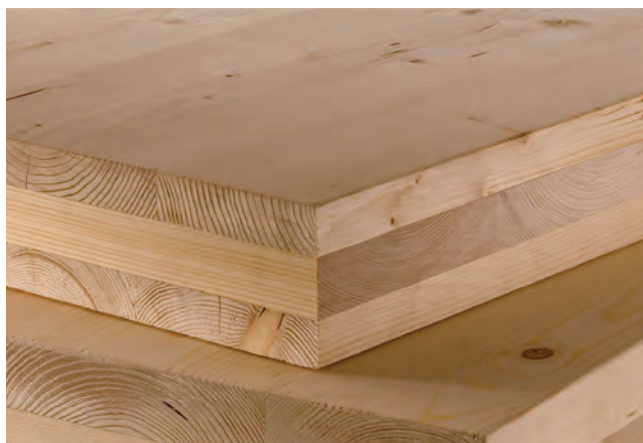
CLT ist ein Massivholz-Bauprodukt, das aus mindestens drei Lagen kreuzweise verklebter Einschichtplatten hergestellt wird. Quelle: Stora Enso Wood Products Austria
