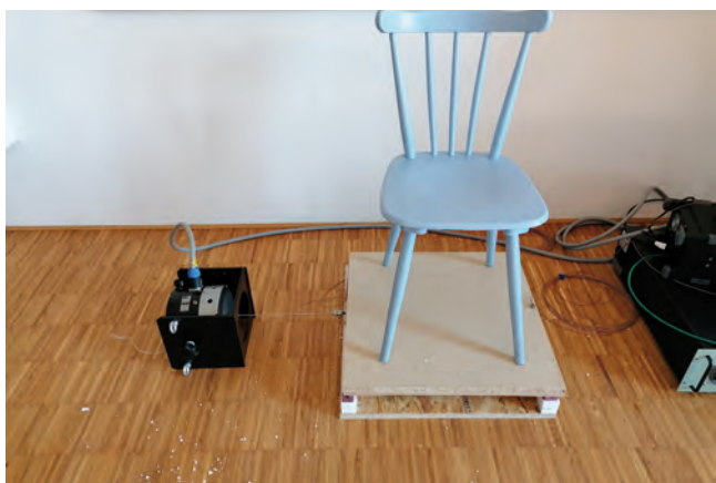
Abb. 4: Testobjekt zur Wiedergabe der Vibrationsstimuli
