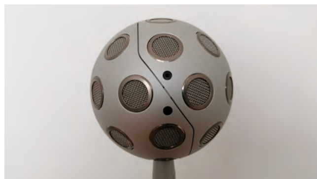
Abb. 1: Eigenmike® zur Aufnahme der akustischen Stimuli mit 32 Mikrofonen
