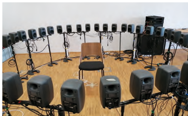
Abb. 2: Wiedergabe der Akustikstimuli mit einem Array von 64 Lautsprechern (in der Testsituation)
